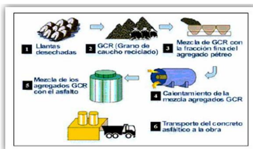
Proceso de polvo de NFU en mezclas asfálticas por vía seca
